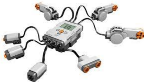
Figura 6. Lego Mindstorms NXT (Lego, 2009) (a) CPU. (b) sensor de toque. (c) sensor de som. (d) sensor de luz. (e) sensor ultra-sônico. (f) servo-motor
