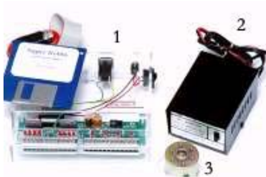
Figura 2 – Kit Super Robby. (1) Interface Super Robby; (2) Fonte de alimentação; e (3) Motor
