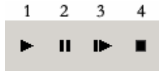
Figura 9 – Botões de controle do simulador. (1) Iniciar a simulação do Meu Mundo/Continuar com a simulação no Meu Mundo; (2) Pausar a simulação do Meu Mundo; (3) Realizar próximo passo da simulação do Meu Mundo; e (4) Interromper a simulação do Meu Mundo
