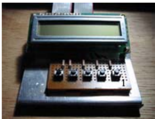
Figura 18 – Display e Teclado. (1) Botão que comanda o início da execução
