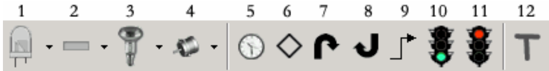
Figura 7 – Objeto Comentário (12), Objetos de Hardware de Saída – (1) Led; (2) Display; (3) Lâmpada; e (4) Motor – e Objetos de Programação – (5) Temporizador; (6) Estrutura de Controle Se; (7) Início de Looping; (8) Fim de Looping; (9) Linha de Programação; (10) Início de Programa; e (11) Fim de Programa – disponíveis na barra de ferramenta da janela Meu Programa
