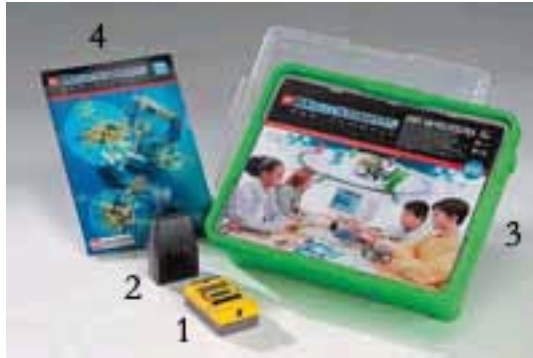
Figura 4 – Lego MindStorms. (1) RCX; (2) Transmissor infravermelho para RCX; (3) Caixa com peças Lego; e (4) Revista com material pedagógico
