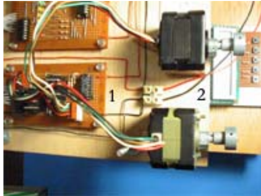
Figura 19 – Plugin de controle dos motores de passo. (1) Placa de circuito do plugin; e (2) Motores de passo
