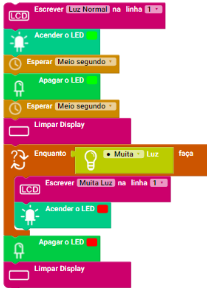
Figura 52: Programa a ser construído na segunda atividade
